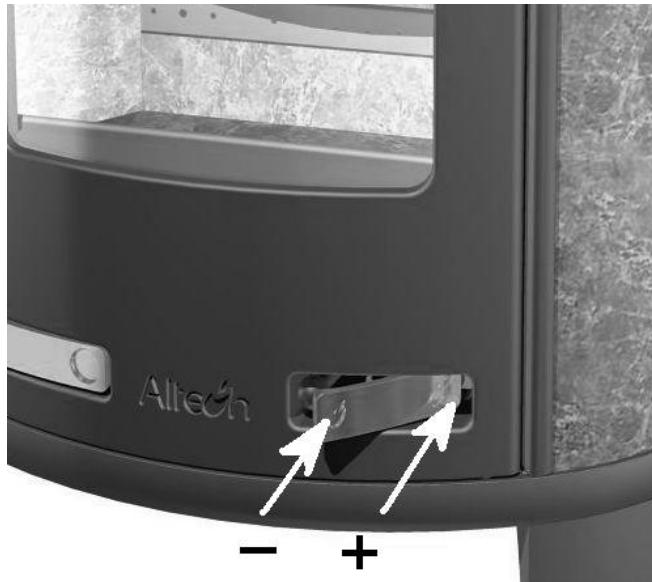
Nachdem das Feuer vollständig erloschen ist und keine Glut mehr im Ofen zu sehen ist, können Sie das Luftventil im Ofen vollständig schließen. Dadurch kann der Ofen länger Wärme abgeben. Öffnen Sie vor der nächsten Befeuerung das Luftventil erneut.
