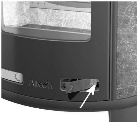
Avlägsna endast den överflödiga askan (alltså inte all aska) . Observera att det kan finnas glödande delar kvar i askan upp till 24 timmar efter att elden släcknat. Töm alltid asklådan i ett brandsäkert kärl.
