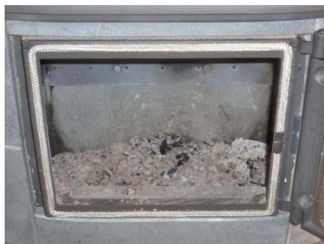
Asche hat eine isolierende Funktion, wodurch in der Verbrennungskammer schneller eine optimale Temperatur entsteht. Entfernen Sie daher die Asche vorzugsweise nicht vollständig.
